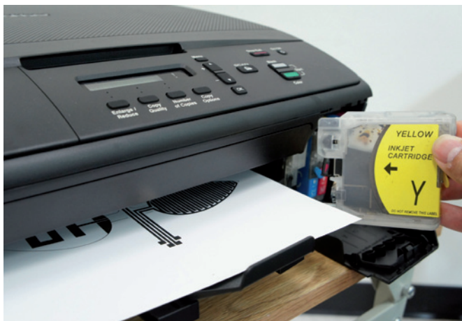
Fot. 5. Prototypowanie obwodu z wykorzystaniem drukarki atramentowej – standardowy wkład napełniony jest tuszem z nanocząsteczkami srebra (źródło: https://www.news.gatech.edu/ )
