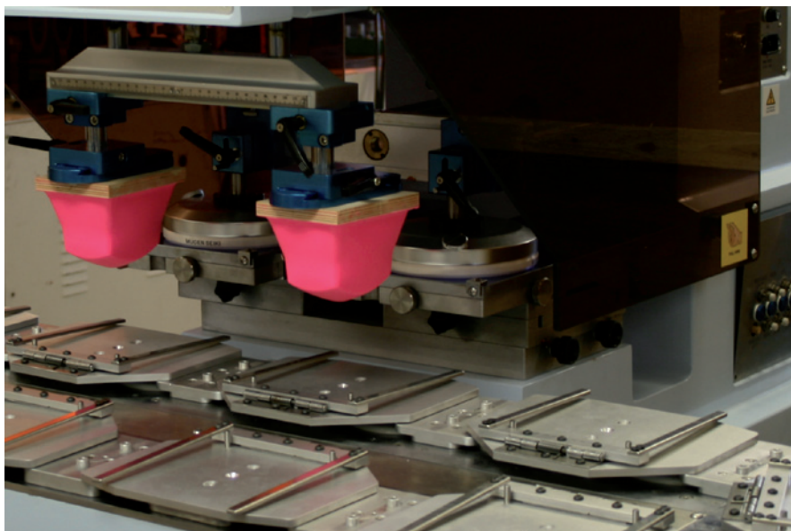
Fot. 2. Fragment tamponiarki z widocznymi stemplami silikonowymi Źródło: Wikimedia Commons, autor: C.andersson, CC BY-SA 3.0, fot. wykadrowana
