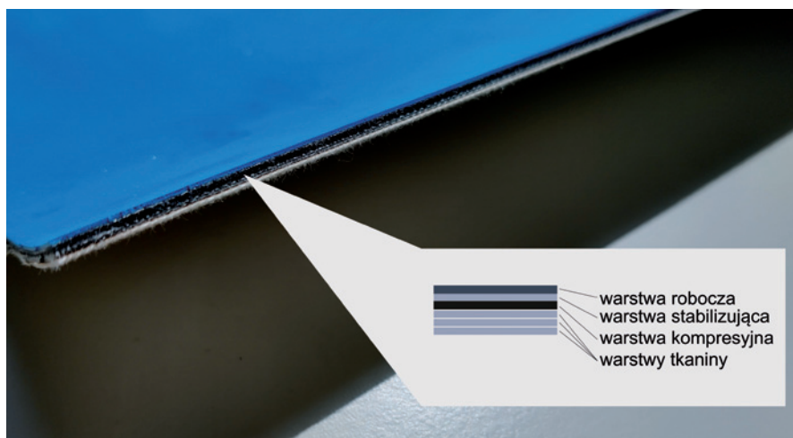
Fot. 6. Offsetowy obciążenie elastomerowe w przekroju
