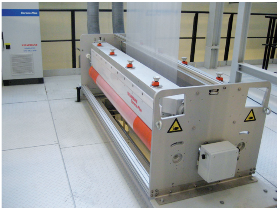
Stacja Corona VE2C – system do aktywacji dwustronnej zamontowany na maszynie Reifenhäuser
