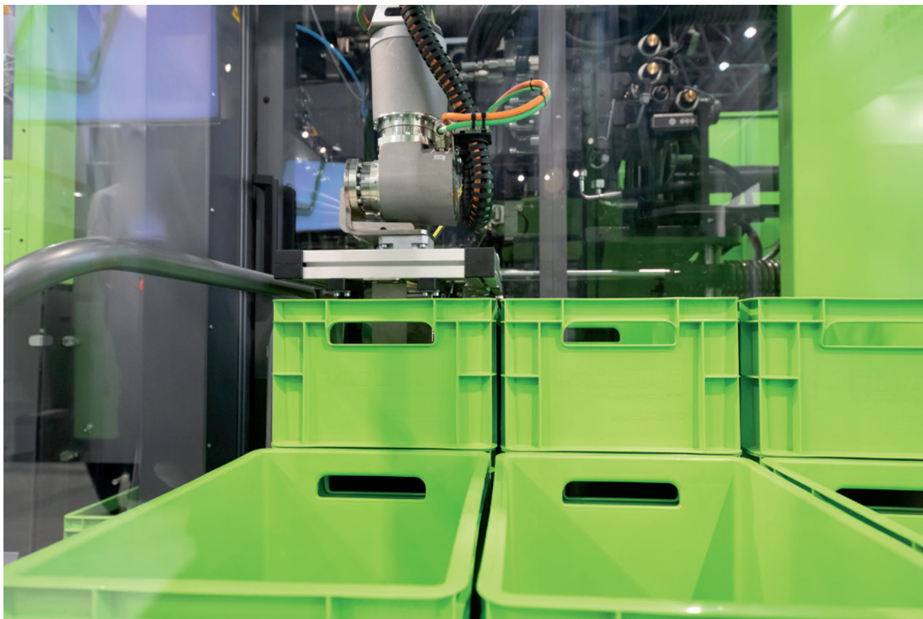
Technologia skinmelt ukrywa recyklat pod powierzchnią materiału pierwotnego – przykład: skrzynki transportowe
