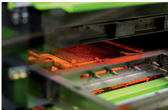
Podgrzewanie mat w procesie organomelt
