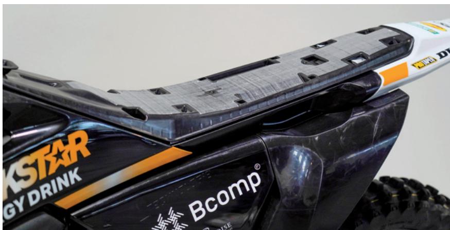
Podstawa siedzenia motocykla wykonana w technologii tape sandwich
