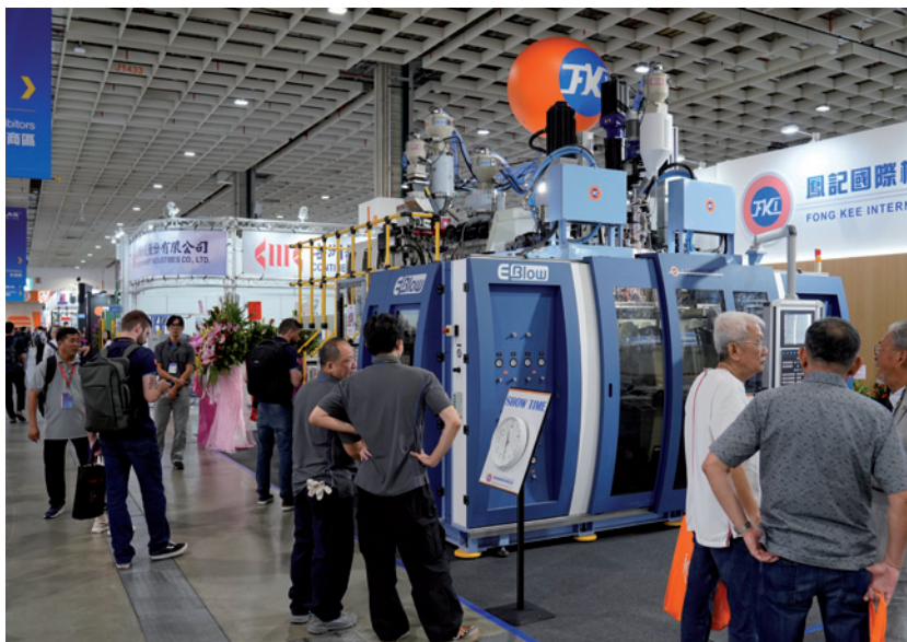
Maszyna do wytłaczania z rozdmuchem wielowarstwowych pojemników na stoisku firmy FKI (Fong Kee International Machinery)
