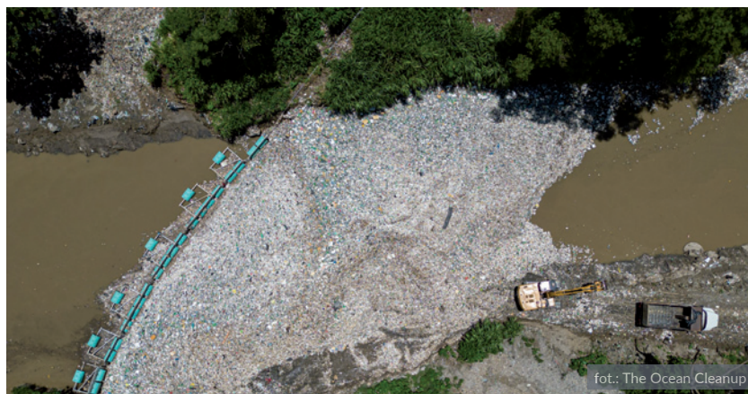
Ocean Cleanup testuje zapórę „Interceptor” powstrzymującą śmieci, które spływają w dół rzeki podczas pory deszczowej w Gwatemali
